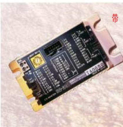
带 2 轴同步圆弧、直线插补 **控制器**
